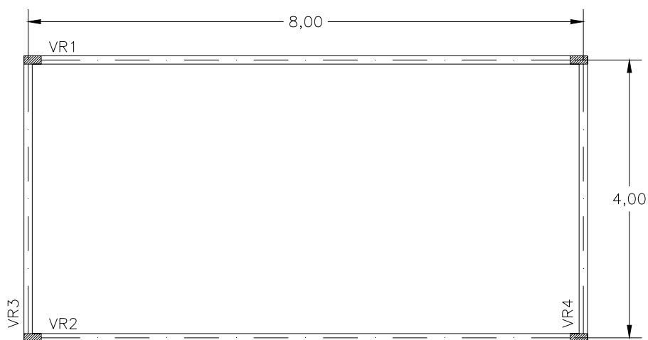
FIGURA 2. Pavimentos (PR) com painel isolado retangular (4m X 8m)
